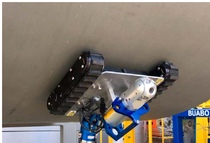
Проверка изогнутых стальных стен
